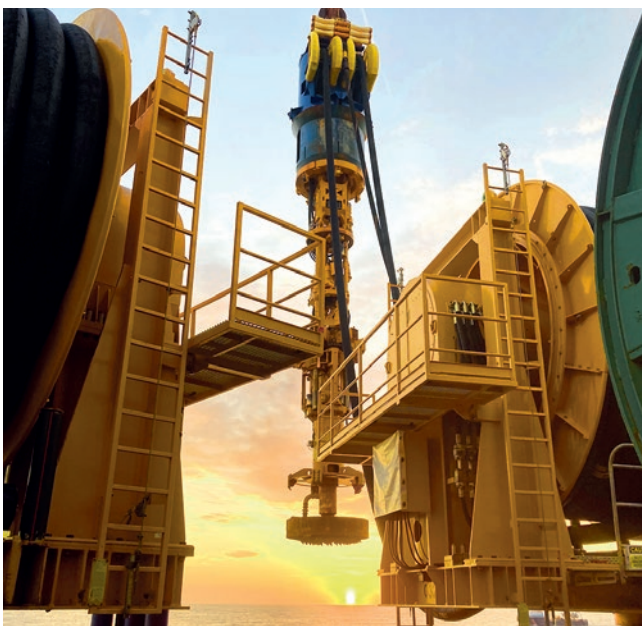
Offshore Windpark, Saint-Brieuc, Frankreich Mithilfe des Dive Drills CU40 wurden bis zu 47 m tiefe Bohrungen mit einem Durchmesser von 3 m ausgeführt.
